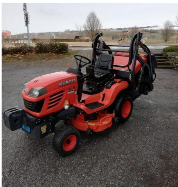
Au mois de juillet, le 2ème tracteur Kubota est tombé en panne. L'atelier mécanique Buffat a alors constaté un problème de boîte à vitesse. L'écrou du pignon d'attaque s'étant desserré, il bloquait le pignon de groupe en position lente. Le véhicule a été remplacé après 23 ans de service, conformément au préavis N° 6/2018.
